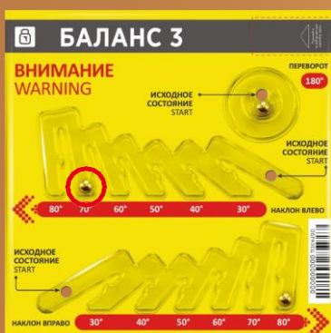
Индикатор в сработавшем состоянии при повороте на 70° влево
